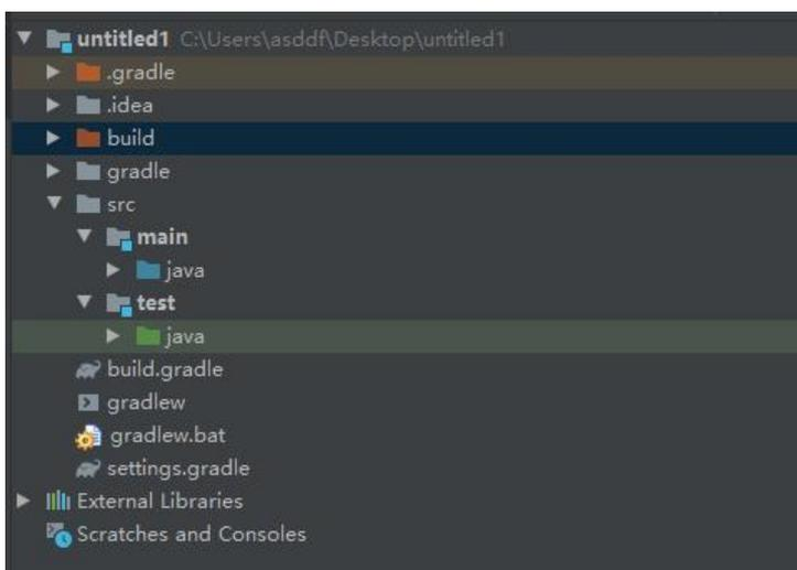
gradle wrapper的优点之一就是可以自定义下载的gradle的版本，如果是团队协作的话，这个功能就非常方便，简单设置即可统一团队的构建工具版本。这里我就设定成目前最新的gradle 6.4.默认下载安的是bin版，仅包含二进制。如果你使用IDEA的话，它会推荐下载all版，包含源代码，这样IDEA就可分析源代码，提供更加精确的gradle脚本支持。
