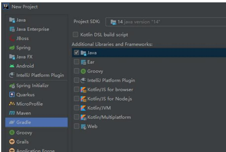
IDEA默认就会使用gradle wrapper来创建项目，所以无需安装gradle也可以正常运行。这时候项目结构应该类似下图所示，使用Maven的同学应该比较熟悉，因为这和Maven的项目结构几乎完全一致。gradle文件夹和gradlew那几个文件就是gradle wrapper的文件，而.gradle后缀名的文件正是gradle配置文件，对应于Maven的pom.xml。
