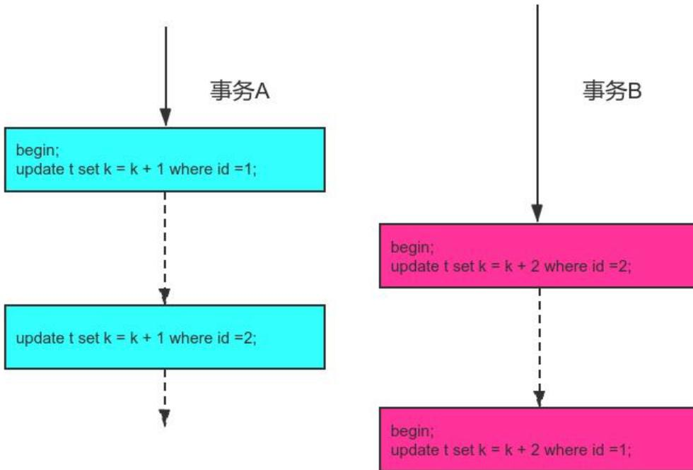
对上图的两个事务，由两阶段锁协议可知：这时候，事务 A 在等待事务 B 释放 id=2 的行锁，而事务 B 在等待事务 A 释放 id=1 的行锁。事务 A 和事务 B 在互相等待对方的资源释放，就是进入了死锁状态。
